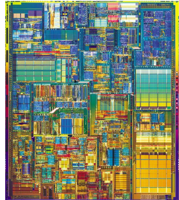
*CPU со снятым корпусом*
