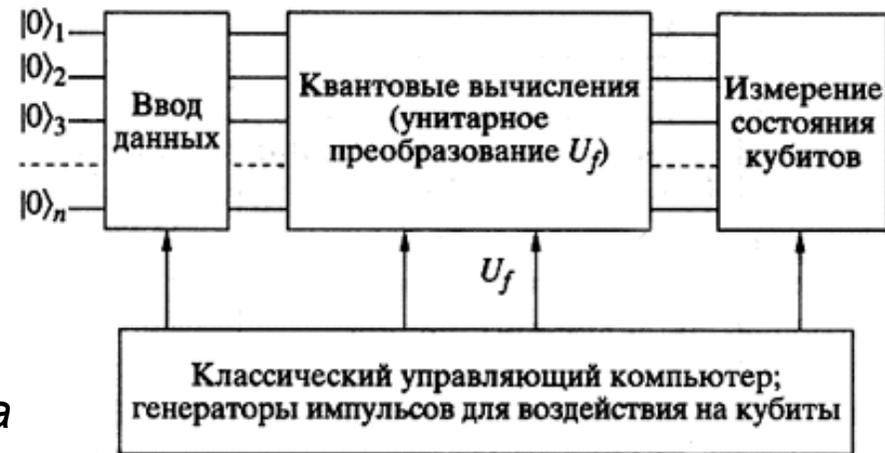
Схема квантового компьютера
